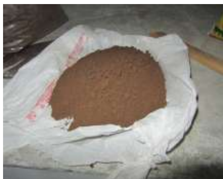
Fig 1. ETP Sludge of TiO 2
